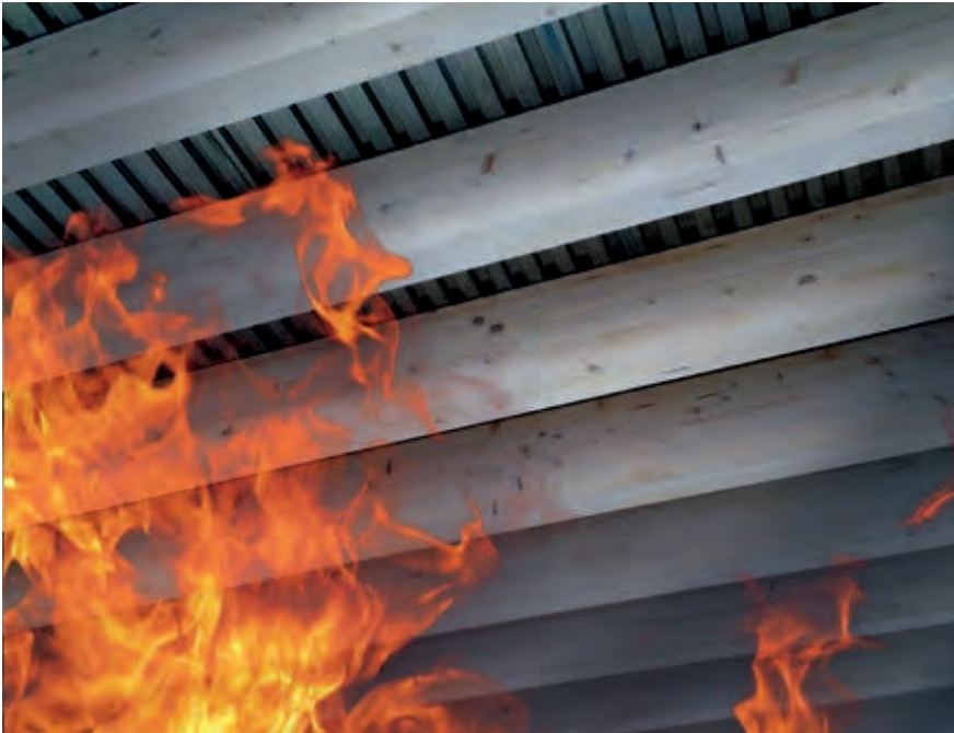
Feuerwiderstand einer Fußbodenkonstruktion mit LEWIS®-Schwalbenschwanzplatten
