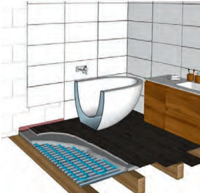
Badezimmerboden mit wasserbeständigem Randanschluss am bestehenden Mauerwerk
