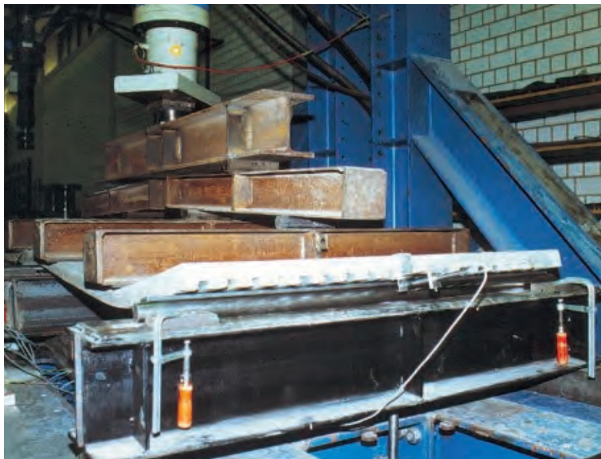
Belastungstest der LEWIS®-Schwalbenschwanzplatten mit Vergussmasse an der Universität Kaiserslautern, Fachbereich Stahlbau
