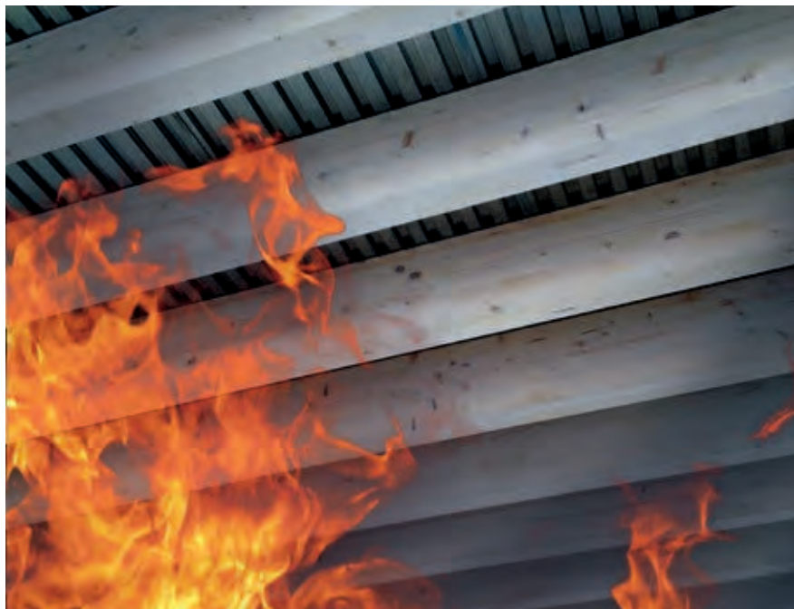
Feuerwiderstand einer Fußbodenkonstruktion mit LEWIS®-Schwalbenschwanzplatten
